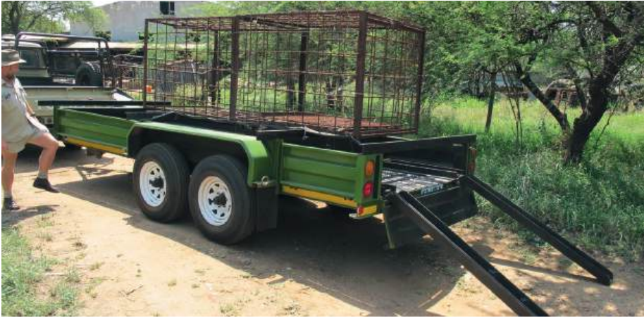
Abb. 4: Geländegängiger Anhänger für die Verladung von schweren Kisten, auch für Nashorntransporte, gesponsert vom Kölner Zoo. All-terrain trailer sponsored by Cologne Zoo, specially constructed for the transport of large and heavy crates including rhino transports.
